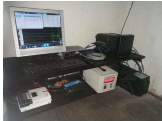
*Slika 2.4 Digitalni seismograf i monitor za praćenje seizmičke aktivnosti*
